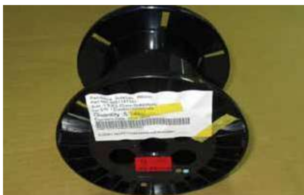
註：回收再使用模組導線帶捲軸
